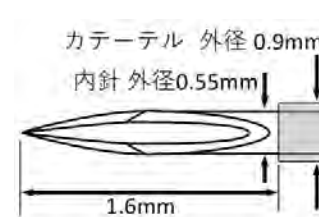
図 3 留置針先端寸法例
